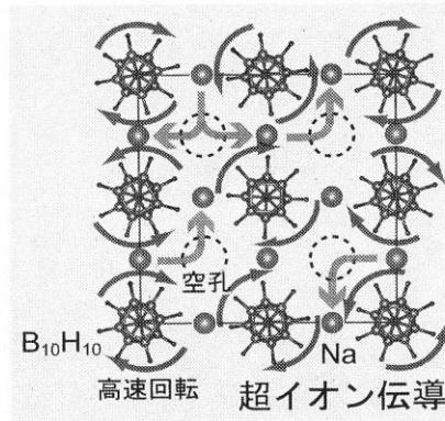
空孔生成と $B_{10}H_{10}$ イオノンの高速回転によるナトリウム超イオン伝導の様子
