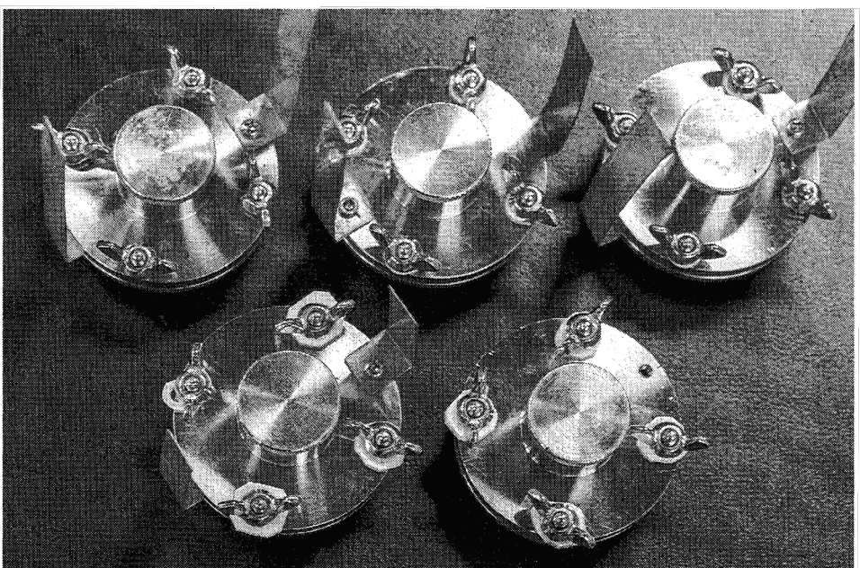
新たな電解質材料(写真上)をもとに試作したカルシウムイオン電池(同下)は安定して充放電ができた。東北大・折茂教授提供
