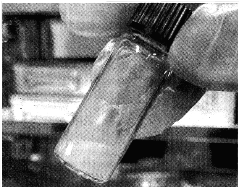
新たな電解質材料(写真上)をもとに試作したカルシウムイオン電池(同下)は安定して充放電ができた。東北大・折茂教授提供
